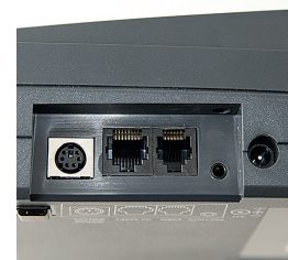
Bezpośrednie podłączenie wagi, czytnika kodów kreskowych, komputera i szuflady na pieniądze
