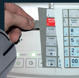
Wymienna wkładka klawiatury w modelu kasy z klawiaturą membranową
