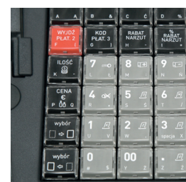
Tradycyjne klawisze w modelu kasy z klawiaturą modułową
